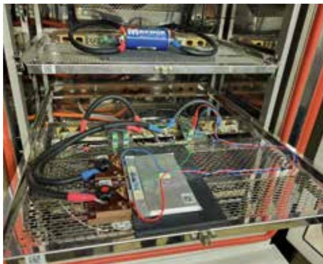
Test d'une cellule dans une enceinte climatique du centre d'essais CRITT M2A.
