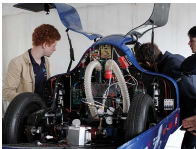
Pile à combustible développée par Polytech Nantes et utilisée dans le véhicule CityJoule.
