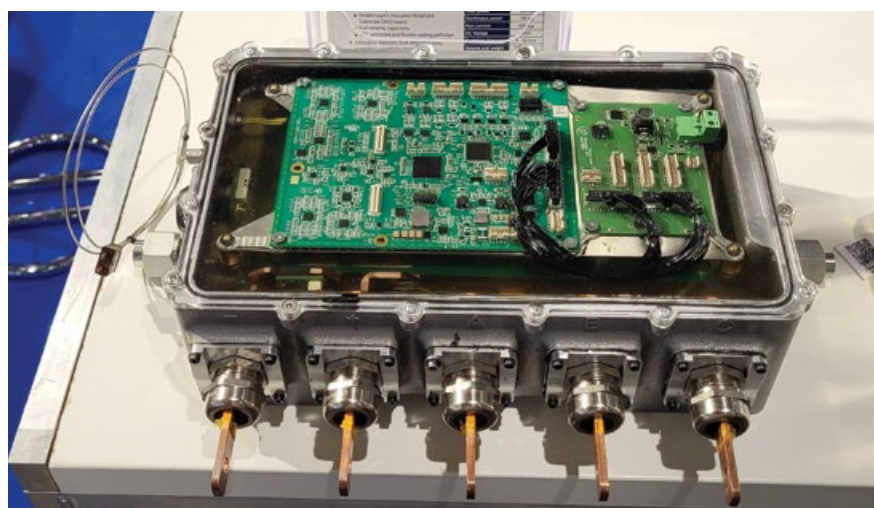
Onduleur refroidi par immersion étudié par l'IFPEN et TotalEnergies.
