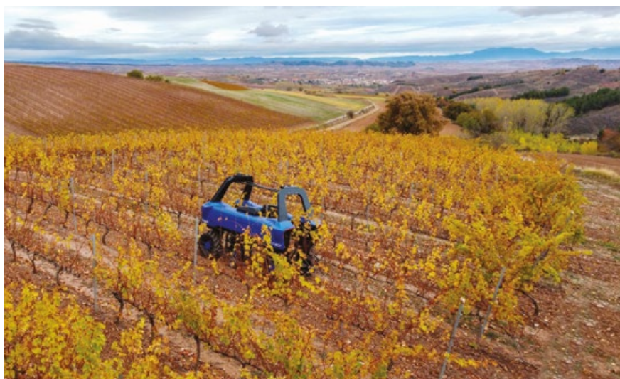
Le robot enjambeur Vitibot Bakus est capable de désherber entre les pieds de vigne avec une grande précision.
