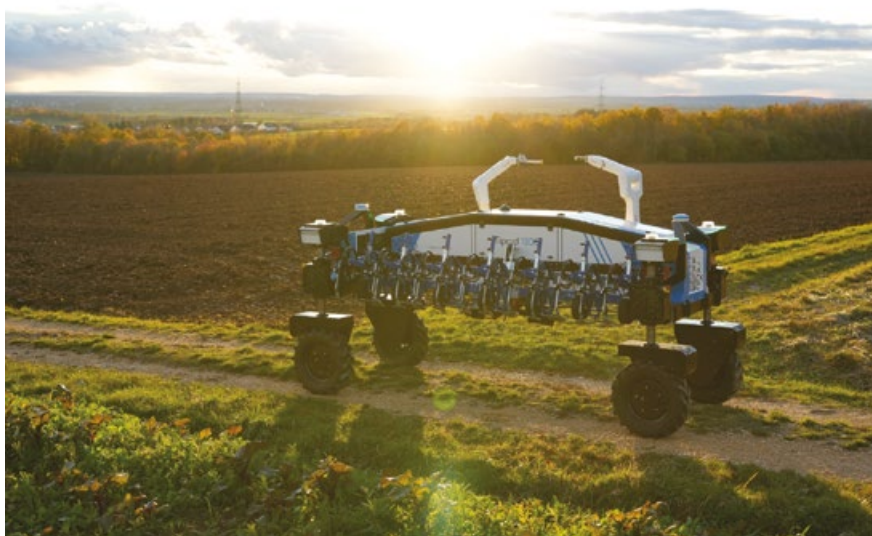
La plateforme multi-porteuse autonome tipard 1500 de Digital Workbench peut semer et biner en toute autonomie.
