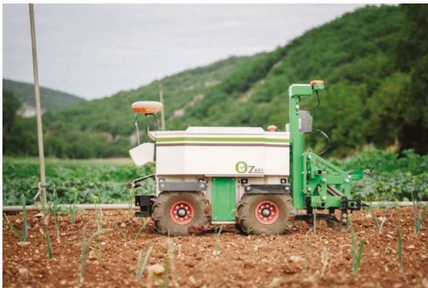
Le robot Oz de Naïo Technologie est un assistant autonome de désherbage en maraîchage et de transport de charge.
