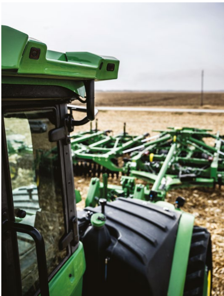
Jusqu'à 16 caméras peuvent équiper le tracteur John Deere 9RX autonome.
